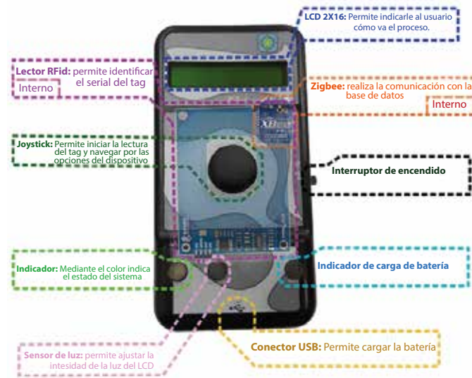
Figura 3. Componentes del módulo lector
