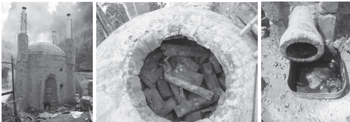
Figura 1. Horno tipo colmena para la producción de Acido Piroleñoso Imágenes Aisales (2013).
